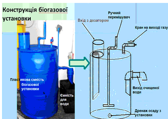
Рис. 2. Дослідно-промислова біогазова установка, об'ємом 200 л, виробництво біогазу – 0.3-0.4 м 3 /добу
