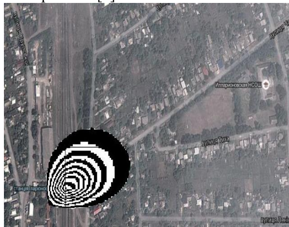
Рис. 1. Зона загрязнения атмосферы для момента времени t=21 сек (уровень Z=10 м, первичное облако)
