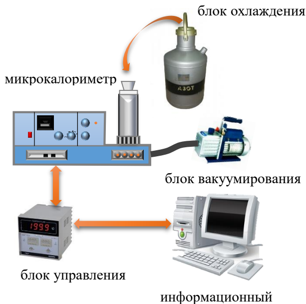
Рис.2. Микрокалориметрический комплекс для определения параметров пористости цементного камня
