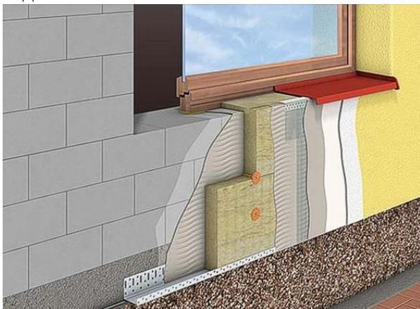
Рис.4. Схема устройства теплоизоляции здания с использованием оштукатуренного фасада
