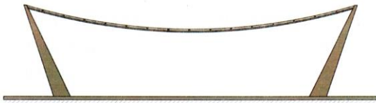
Рис. 10. Схема здания с гибкой нитью в покрытии
