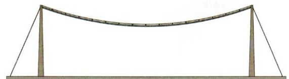
Рис.9. Статическая схема работы гибкой нити
