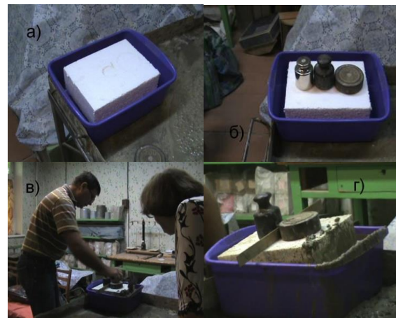
Рис. 5. Проведение эксперимента по определению силы всплытия вкладыша: а) – вкладыш из пенополистирола; б) – пригруз вкладыша; в) – заполнение емкости СУБ; г) – всплытие вкладыша
