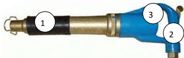
Рис. 1. Зони (точки) поверхні пневматичного молотка ПП-4010, в яких проводились заміри температури
