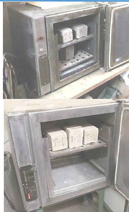
Рис.2. Нагрев образцов в электрических печах
