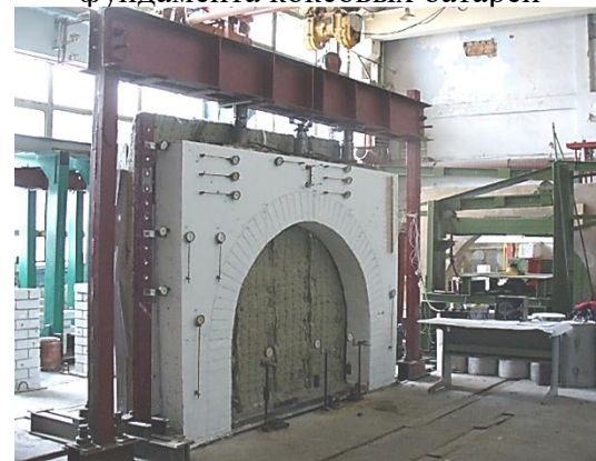
Рис. 7. Силовая металлическая рама для создания вертикальной нагрузки
