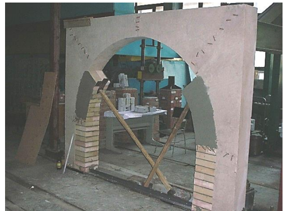
Рис. 6. Футеровка модели фрагмента №1 фундамента коксовых батарей
