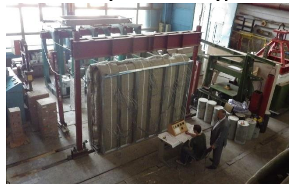
Рис. 8. Раздвижные рамы с теплоизолятором - матами из минеральной ваты для проведения испытаний при воздействии температуры
