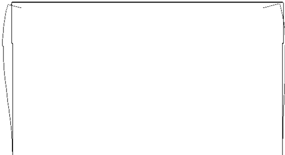
Рис. 5. Деформированная схема поперечной рамы с реальными жесткостями колонн в ее расчетной схеме
