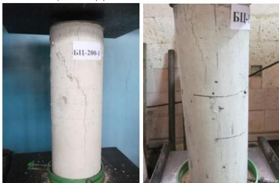
Рис. 6. Характер разрушения образцов серии БЦ-200 и БЦ-150
