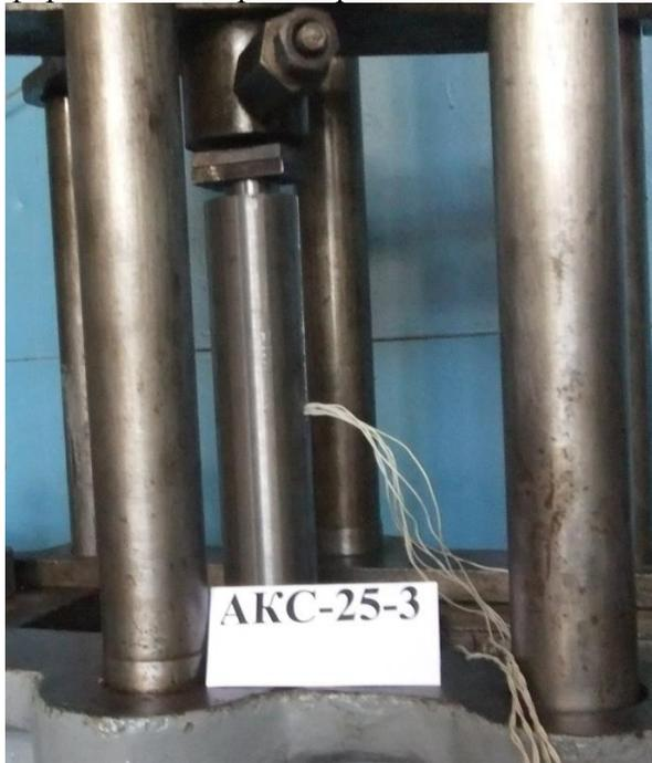
Рис. 2. Общий вид испытанных образцов серии АКС на сжатие
