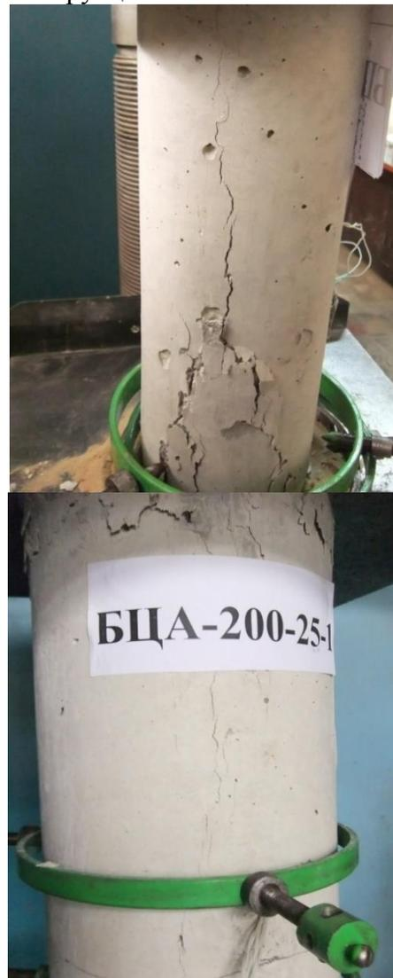
Рис. 9. Характер разрушения стеклопластбетонных образцов при сжатии
