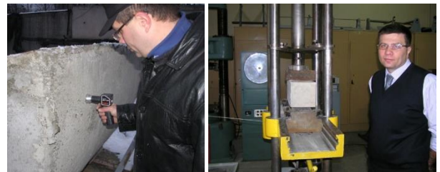
Рис. 2. Определение прочности торкрет-фибробетона монолитной железобетонной оболочки
