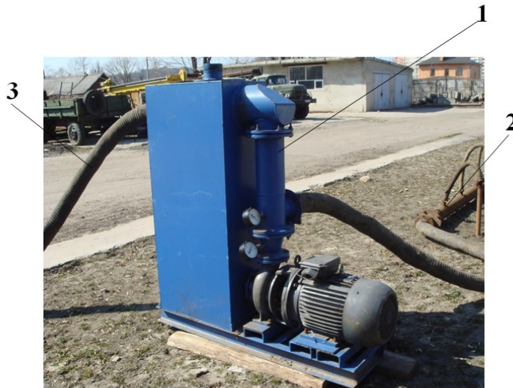
Рис. 1. Общий вид установки ПУВВ-5М: 1 – приводная станция установки; 2 – линейная всасывающая система с иглофильтрами; 3 – сливная линия
