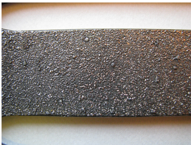
Рис.3. Внешний вид поверхности образця, упрочненного сплавом Т15К6
