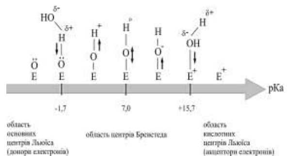
Рис. 1. Формальна схема утворення гідроксильного шару поверхні
