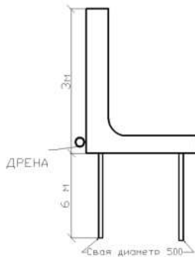
Рис. 3. Предложенная конструкция передвижной подпорной стенки №2.
