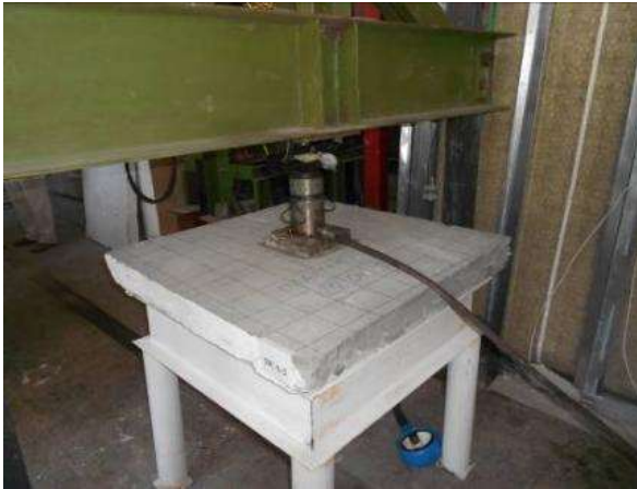
Рис.9. Испытание опытных образцов плит
