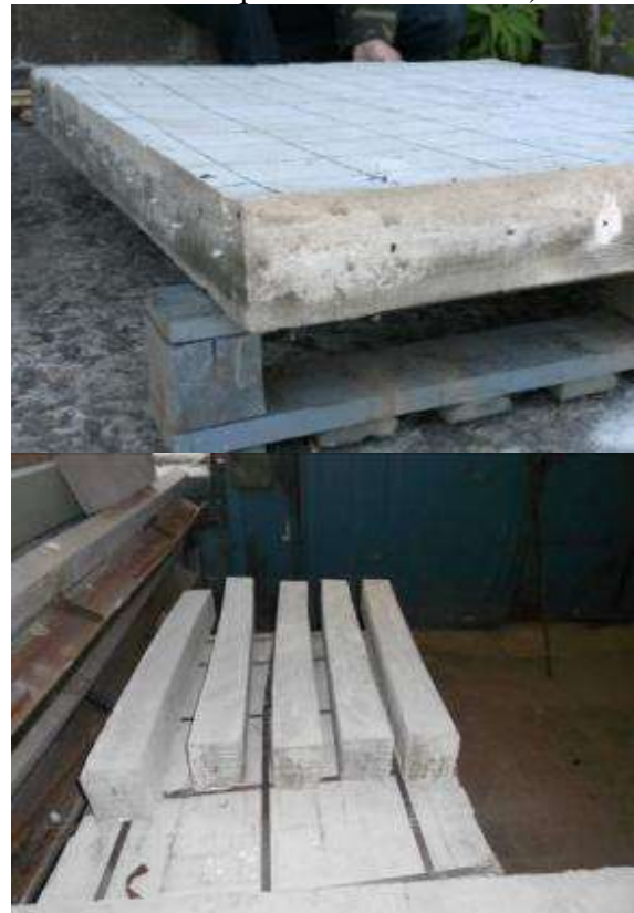
Рис. 1. Опытные образцы плит и балок
