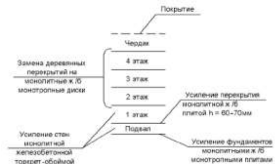
Рис. 14. Схема расположения элементов усиления
