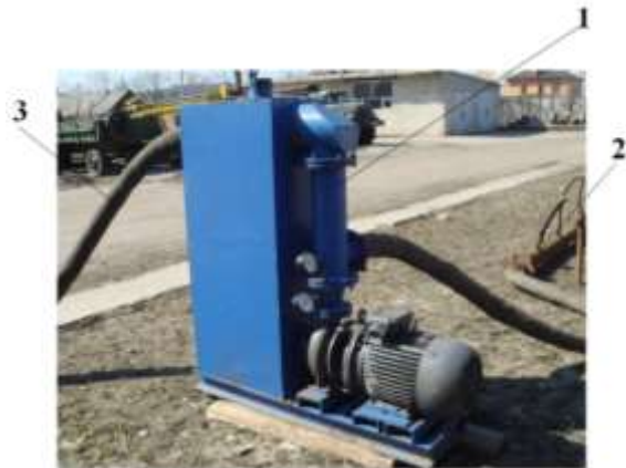
Рис. 1. Общий вид установки ПУВВ-5МЕА: 1 – полиструйный насос приводной станции установки; 2 – линейная всасывающая система с иглофильтрами; 3 – сливная линия.
