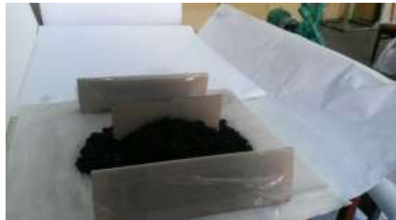
Рис. 6. Зона загрязнения возле модели штабеля угля при наличии защитных экранов с обеих сторон штабеля и наверху штабеля
