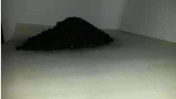
Рис. 4. Зона загрязнения возле модели штабеля угля при покрытии его поверхности специальным раствором
