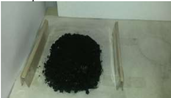
Рис. 5. Зона загрязнения возле модели штабеля угля при наличии боковых защитных экранов
