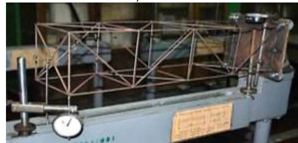
Рис. 3. Фото экспериментальной установки и модели секции мачты
