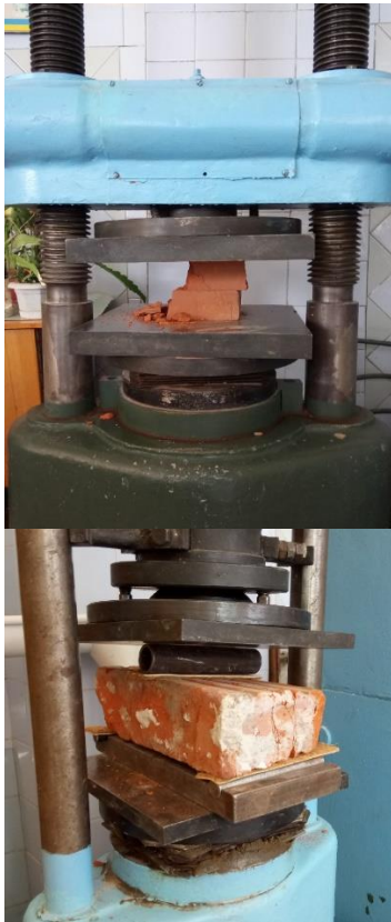
Рис. 2. Испытания образцов кирпича для определения предела прочности при сжатии и изгибе
