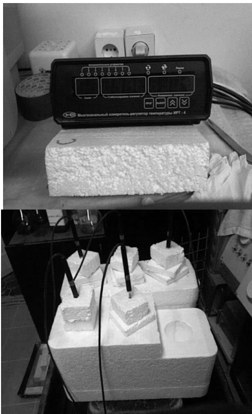
Рис. 1. Зовнішній вигляд приладу для реєстрації зміни температури цементного тіста.
