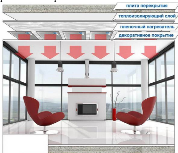
Рис. 1. Принципиальная схема инфракрасного отопления помещения с использованием потолочных пленочных электрических обогревателей
