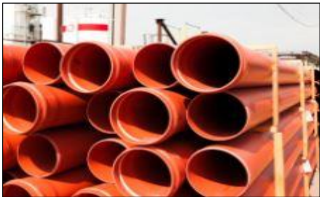
Рис. 4. Канализационные трубы из поливинилхлорида
