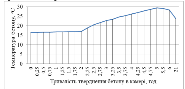
Рис. 3. Зміна температури бетону при його твердінні в лабораторній камері
