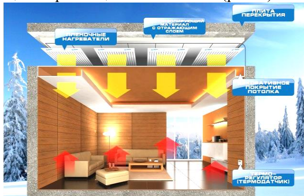
Рис. 2. Принципиальная схема инфракрасного отопления помещения с использованием электрических пленочных обогревателей модели «ЗЕБРА»
