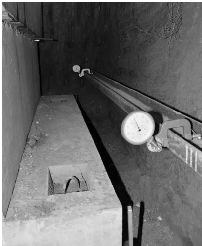
Рис. 2. Определение осадок штампа-2,0м 2 с помощью прогибомеров БПАО, расположенных на реперной системе
