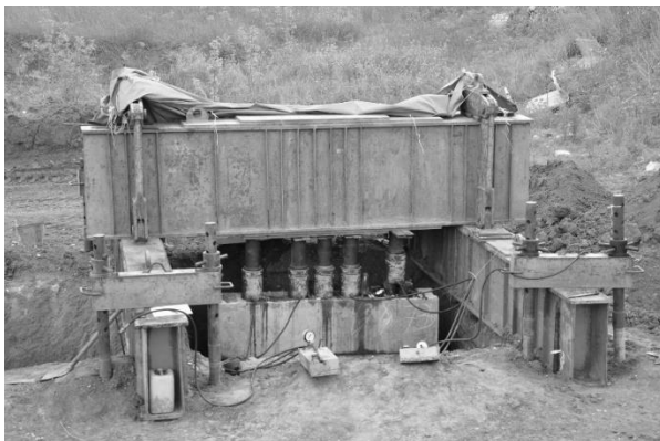
Рис. 3. Общий вид анкерного стенда при испытаниях
