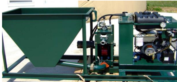
Рис. 4. Шланговий бетононасос GHP 1500 з бензиновим двигуном Honda
