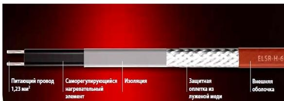
Рис. 6. Основные элементы нагревательного саморегулирующегося кабеля ELSR-H
