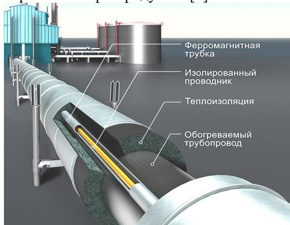
Рис. 4. Схема линейного способа укладки индуктивного нагревательного кабеля на поверхности трубопровода, используемого для перекачки нефтепродуктов.
