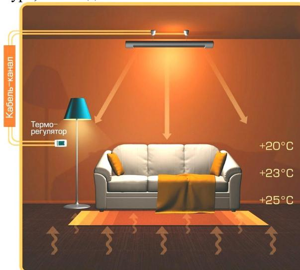
*Рис. 1. Схема обогрева помещения с помощью инфракрасного кварцевого прибора потолочного типа*
