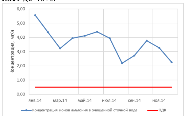
Рис. 5. Концентрация ионов аммония в очищенной сточной воде
