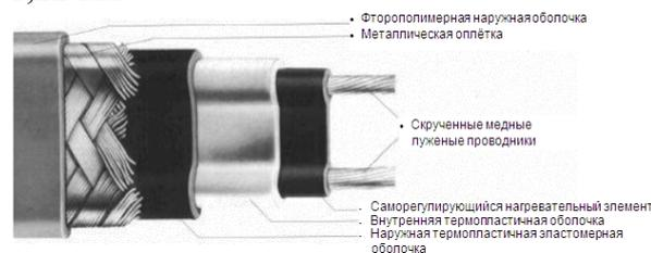
Рис. 5. Устройство гибкой саморегулирующейся нагревательной ленты типа КТ-ј.
