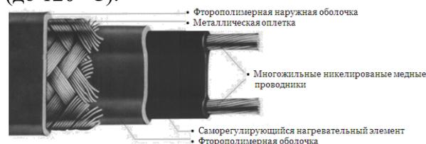
Рис. 6. Устройство гибкой саморегулирующейся нагревательной ленты типа НКТ-*j*.
