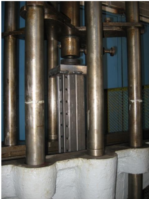
Рис. 5. Испытание короткой стойки
