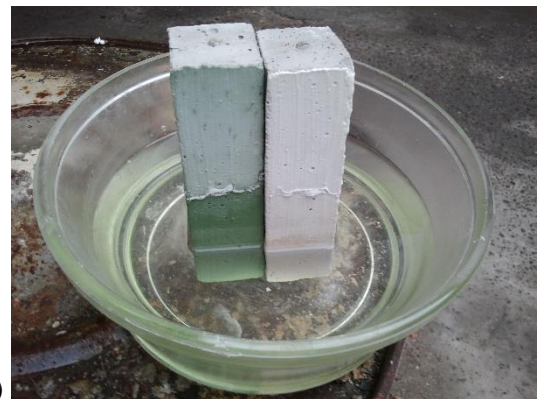
Рис. 6. Випробування декоративних цементів: а – на стійкість кольору, б – на капілярний підсос.
