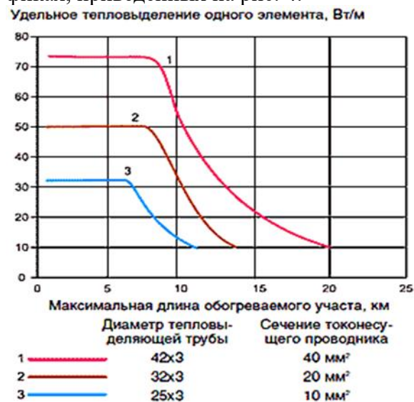
Рис. 4. Графики зависимости удельного тепловыделения одного элемента различных по размерам нагревателей от длины обогреваемого участка трубопровода.
