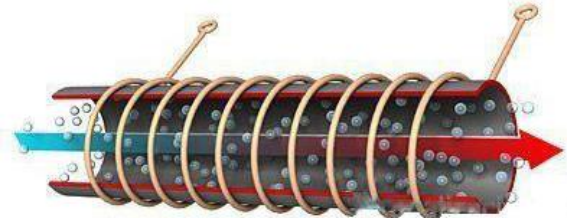
Рис. 3. Принципиальная схема работы индуктивного кабеля, используемого в системах антиобледенения кровель и водостоков зданий [7].
