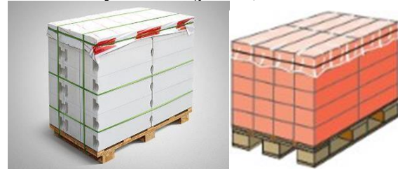
Рис. 5. Варіанти пакування виробів на палеті.
