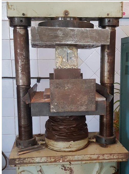
Рис. 2. Лабораторные испытания образцов: а – состояние образца после пребывания в агрессивной среде шахты; б – испытание образца на прочность при сжатии.
