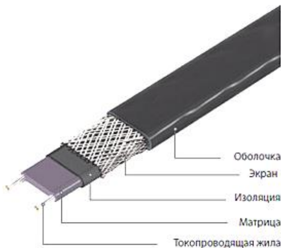
Рис. 3. Схема конструкции саморегулирующегося нагревательного кабеля
