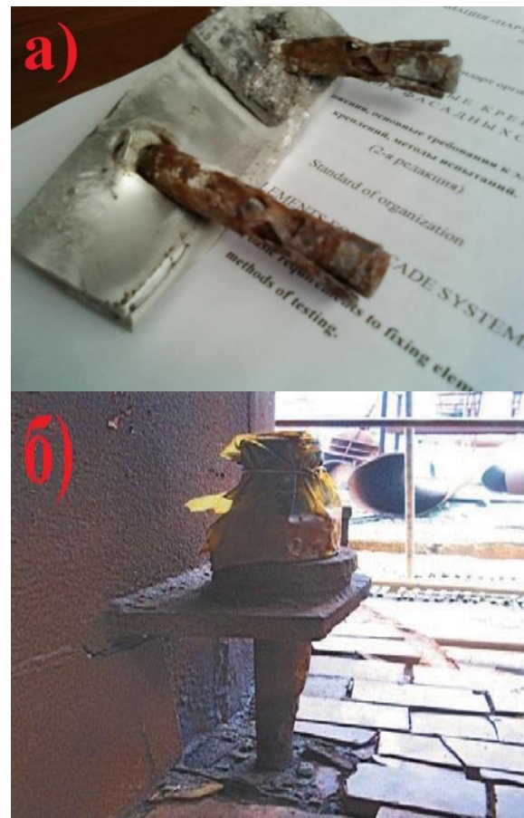
Рис. 1. Дефекти анкерних кріплень: а - оцинкований анкер після 7 років експлуатації в умовах агресивного навколишнього середовища; б – зміна початкової геометричної форми анкера внаслідок розгерметизації під дією високих температур.
