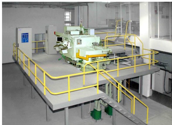
Рис.1. Загальний вигляд промислової електронно-променевої установки ЛЛ-5
