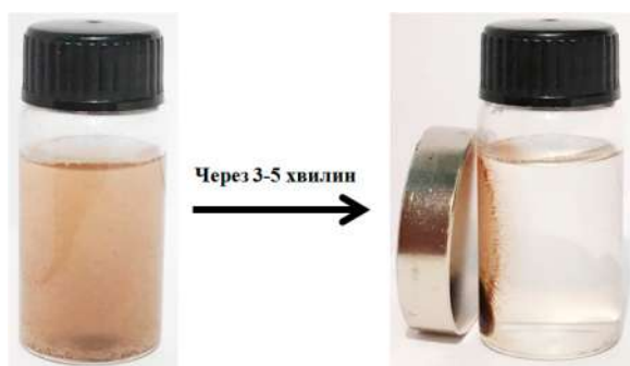
Рис.5. Вилучення функціоналізованого магнітного адсорбенту з сорбційного середовища
