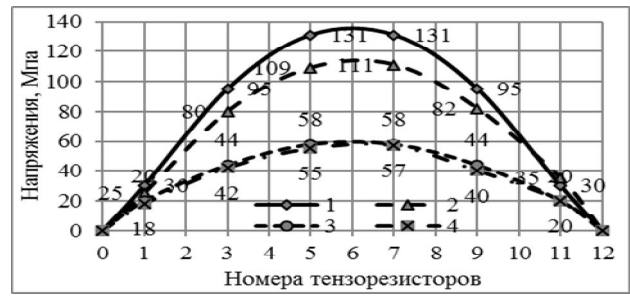
Рис. 6. Напряжения в нижнем поясе (загружение половины пролета): 1-теоретические и 2-экспериментальные значения нагруженного пояса; 3-теоретические и 4-экспериментальные значения ненагруженного пояса
