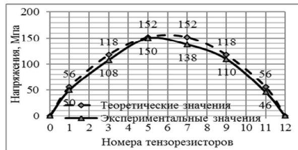
Рис. 8. Напряжения в нижнем поясе (загружение всего пролета):
