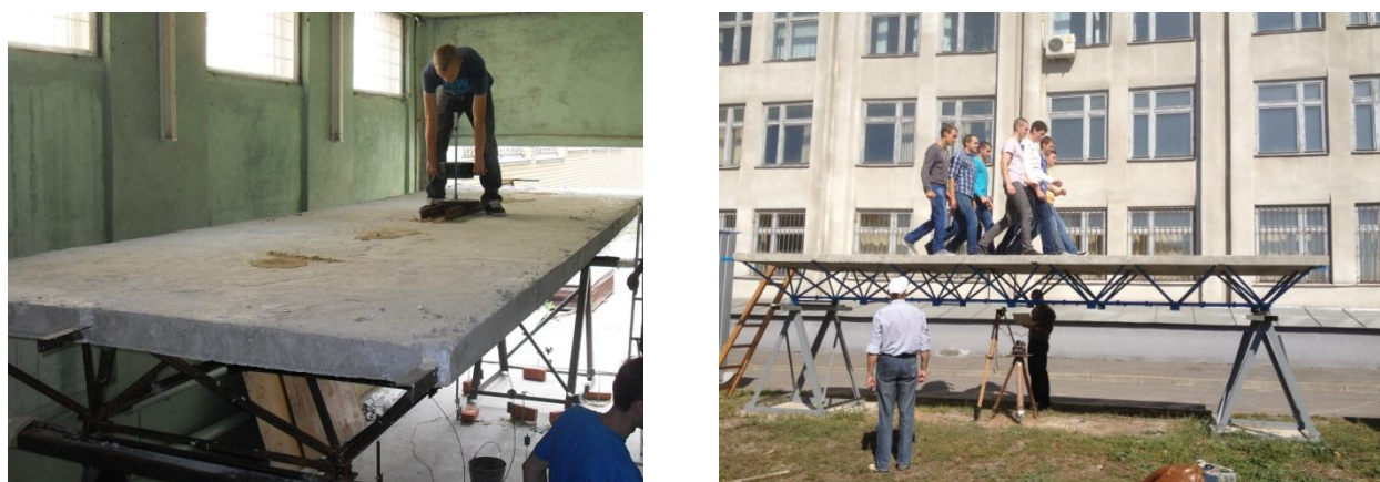
Рис. 2. Динамические испытания сталежелезобетонного модуля пролетного строения
