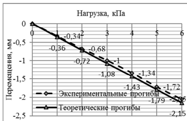
Рис. 3. Деформации середины пролета (загружение четверти пролета)
