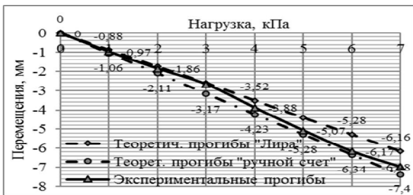
Рис. 7. Деформации середины пролета (загружение всего пролета)
