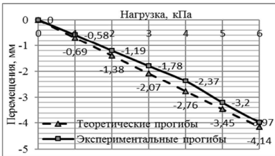
Рис. 5. Деформации середины пролета (загружение половины пролета)
