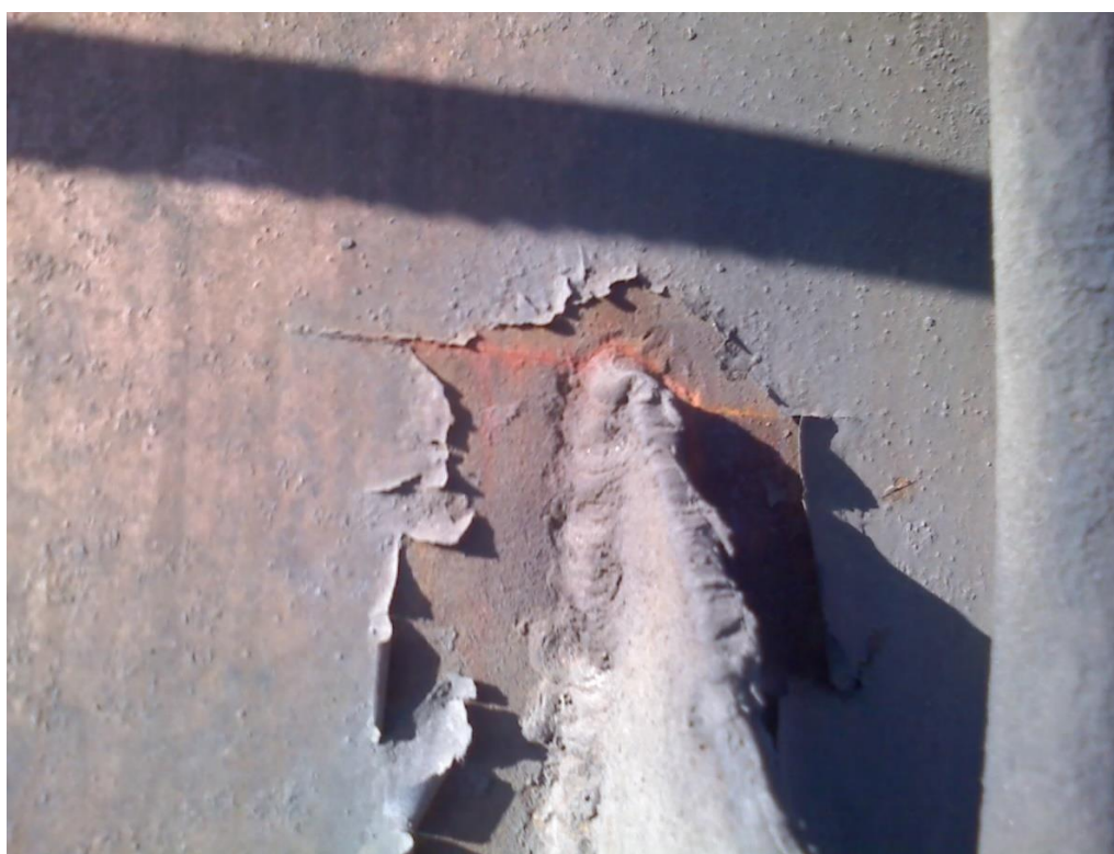
Фото 3 - Тріщина у вертикальній стінці у місці зварювання з кронштейном кріплення майданчика механізму пересування
