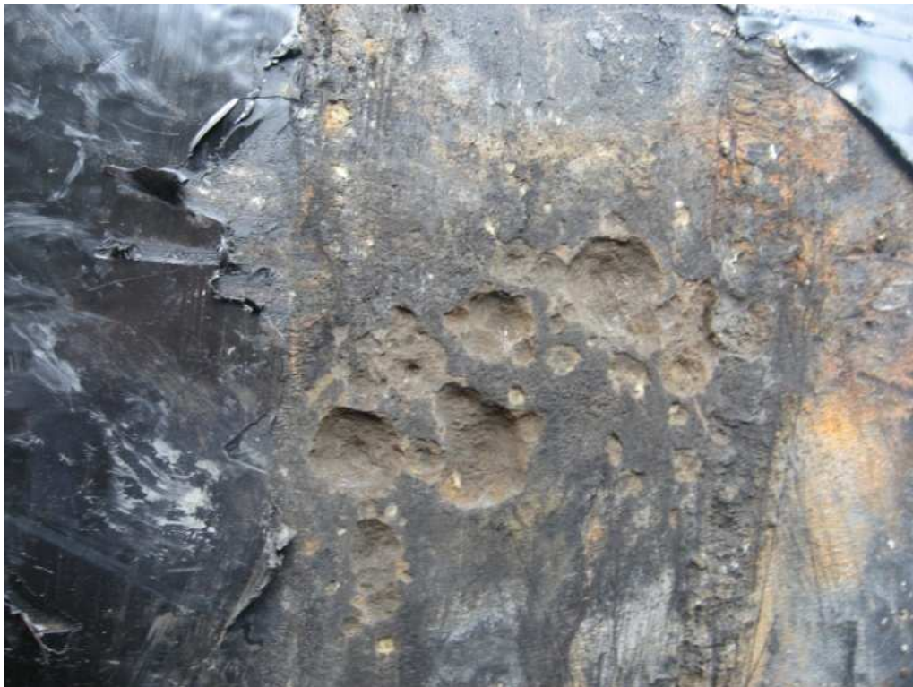
Рисунок 2 – Деградація бітумного покриття
