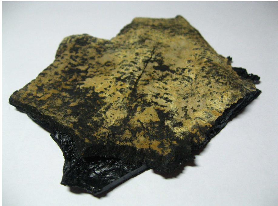
Рисунок 3 – Пошкоджене бітумне покриття з МГ «Пасічна-Долина» (болотиста ділянка)
