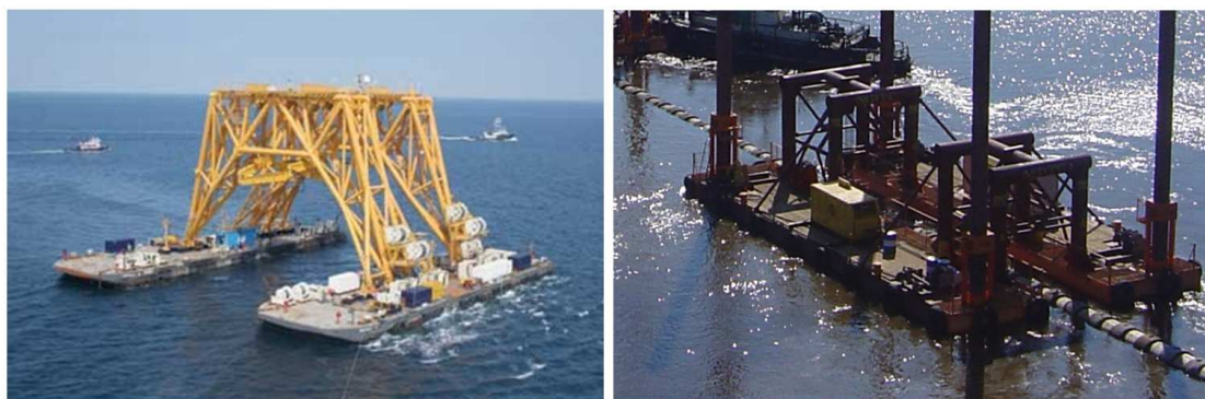
Рисунок 15 – Плаваючі опори розміщені на баржах
