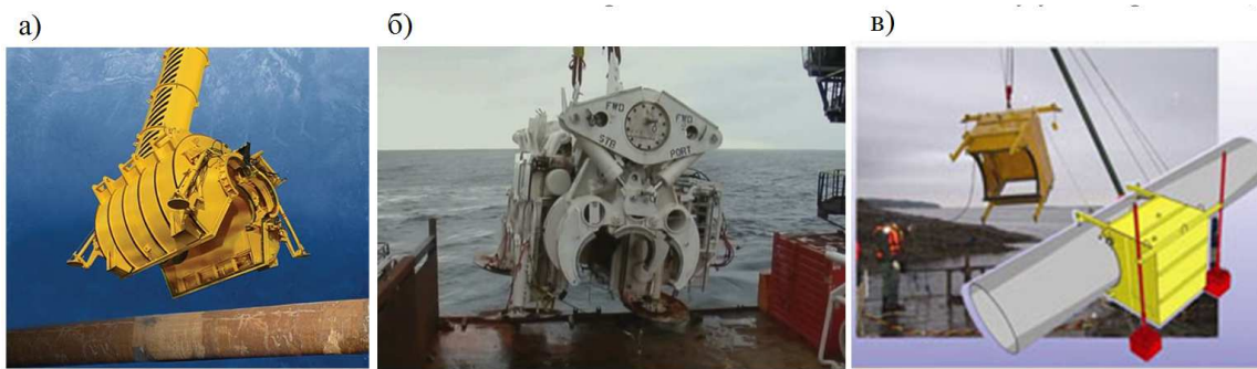
а) – підводна камера з шахтним колодязем; б) – великий глибоководний кесон; в) – водолазний дзвін
