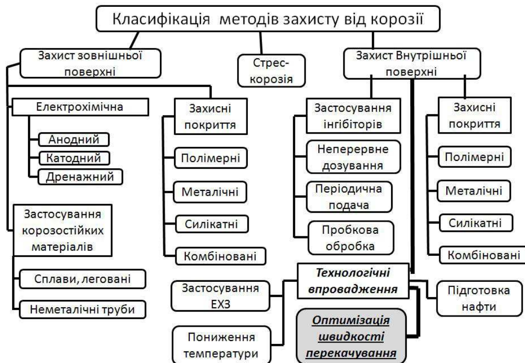
Рисунок 1 – Функціональна модель методів захисту від процесів корозії
