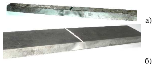
Рисунок 4 – Загальний вигляд досліджуваних зразків з прямокутним перерізом із сталей 10Г2БТЮЗ (а) та 17Г1С (б)
