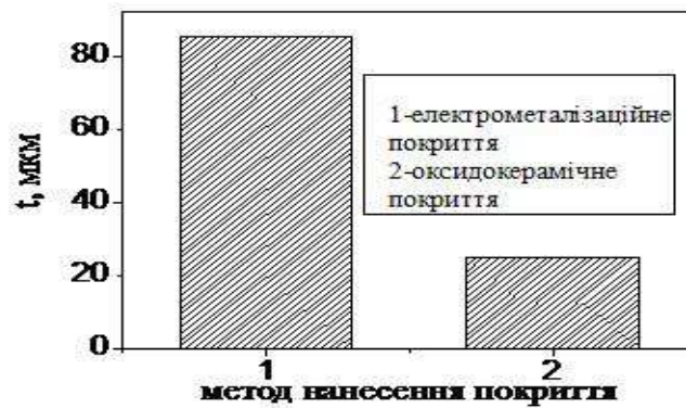
Рисунок 2 – Залежність товщини покриття від методу його нанесення
