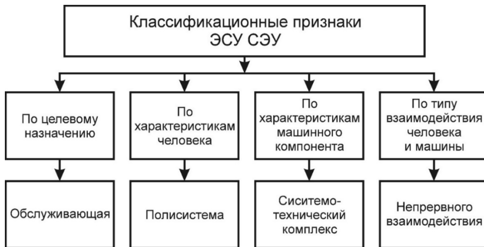
Рисунок 2 – Классификационные признаки эргатической системы управления эксплуатацией СЭУ при стоянке судна в порту/на рейде
